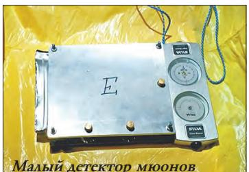
части крепости Нарын-кала (Дербент). Исследование было проведено с помощью метода мюонной радиографии - современного способа сканирования внутренней структуры веществ. Информация с датчиков обрабатывается.
